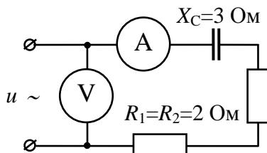
Определить показание вольтметра, если амперметр показывает 10А.
