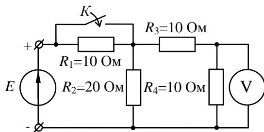
Определить показание вольтметра после замыкания ключа К, если до замыкания он показывал 100 В.
