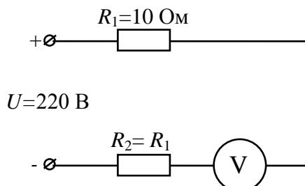
Определить показание вольтметра, ошибочно включенного, как показано на схеме.
