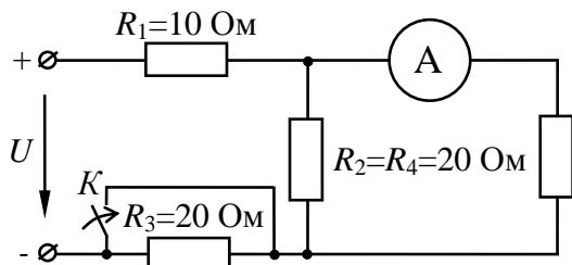
Определить показание амперметра после замыкания ключа  $K$ , если до замыкания он показывал ток 2 А.
